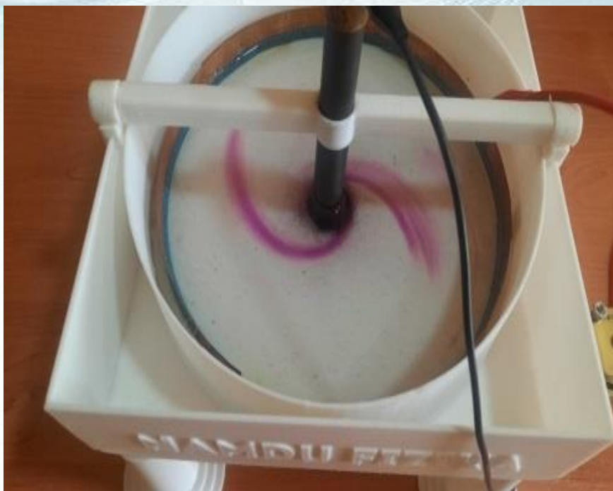
Рисунок 1. вид вращательного движения ионов в магнитном поле.
